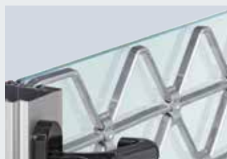
Som ekstraudstyr kunststofrude som heldækkende beskyttelse mod, at personer kan stikke hænderne ind
