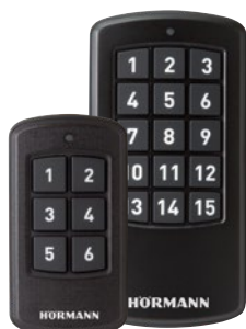
Industrihåndsender HSI 6 BS, HSI 15 BS Til styring af op til 6 porte (HSI 6 BS) eller 15 porte (HSI 15 BS), med ekstra store knapper til nemmere betjening med arbejdshandsker, stødsikkert hus Kapslingstype IP 65
